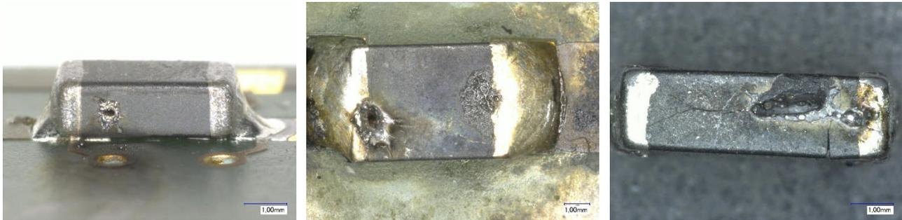
Abbildung 10: Durch Überstrom und Überhitzung geschmolzene und durchgebrannte Chipferrite
